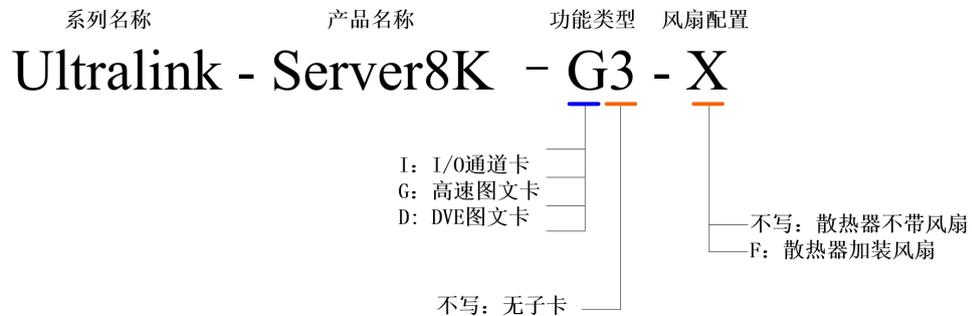
Ultralink-Server8K 板卡命名分 4 个字段，首字段表示系列名称，固定为 Ultralink；第 2 字段表示产品名称，固定为 Server8K。
